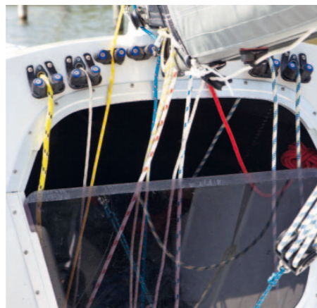
BOVEN Met twee grootschootklemmen kan de schoot zonder problemen worden bediend.
